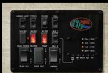
LE CENTRE DE COMMANDES SIERRA VOUS PERMET DE SURVEILLER LES RÉSERVOIRS ET AUTRES SYSTEMES RAPIDEMENT ET FACILEMENT.
