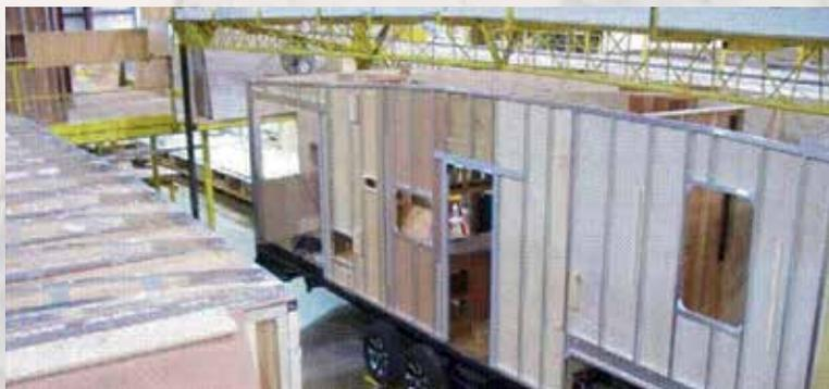
Montants de murs de côtés et fermes de toit en aluminium et centrés aux 16" ou moins
