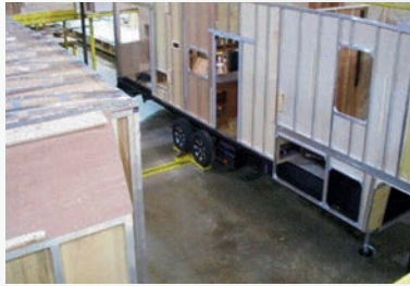
Célèbre superstructure toute en aluminium de Cedar Creek (toit, murs latéraux et plancher) centrée aux 16" ou moins
