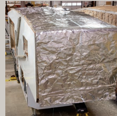
Protection radiante Therma-foil -R-38 dans le plafond, en dessous et en avant de l'unité.
