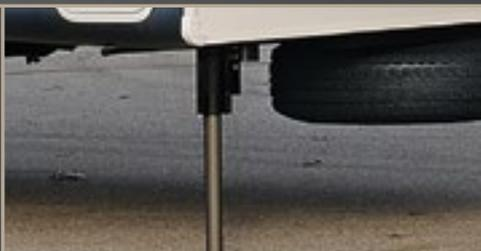
BÉQUILLES AVANT HYDRAULIQUE À LARGE ESPACEMENT.
