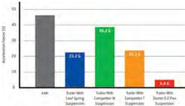
Comparez les forces d'accélération d'un essieu et d'une caravane qui traverse une voie ferrée à 30 miles/h. Le système E-Z Flex® fournit jusqu'à 80 % de réduction des forces sur le châssis de la caravane versus un égaliseur standard. De plus, E-Z Flex® surpasse significativement tous les autres concurrents dans le même essai sur route. Le résultat? Une conduite beaucoup plus souple et plus de protection pour votre unité et vos biens.
