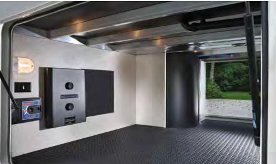
Le châssis en Z Hathaway du coffre avant est chauffé et procure une capacité de rangement de 100 pi<sup>3</sup> et comprend une sortie pour l'aspirateur central pour nettoyer par l'extérieur.
