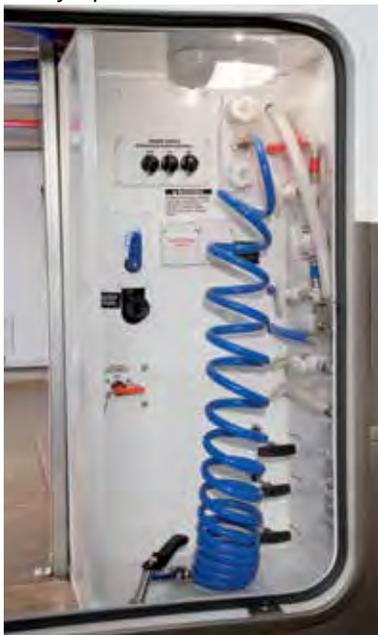
Station de connexion incluant une douche extérieure, système de rinçage pour eaux noires, tuyau de contournement, coupe-batterie de 12 volts, interrupteur de sélection, poignée pour vidanger des réservoirs, remplissage d'eau fraîche, le tout centralisé.
