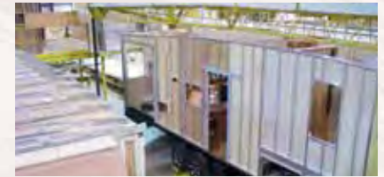
Murs latéraux et charpentes de toit en aluminium centrés aux 16" ou moins
