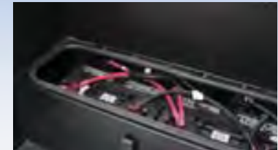
Deux batteries rangées au même endroit afin d'en faciliter l'accès. (Une batterie sur les modèles LE et Transit)
