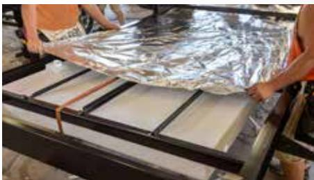
Réservoirs de rétentions chauffés, dessous de l'unité fermé, une fournaise plus grande, une membrane radiante en aluminium dessous l'unité, ce qui vous procurera un confort additionnelle sur le devant et les planchers d'extension. (Éléments chauffants de série, Signature et Ultra Lite et en option sur Mini & Roo)
