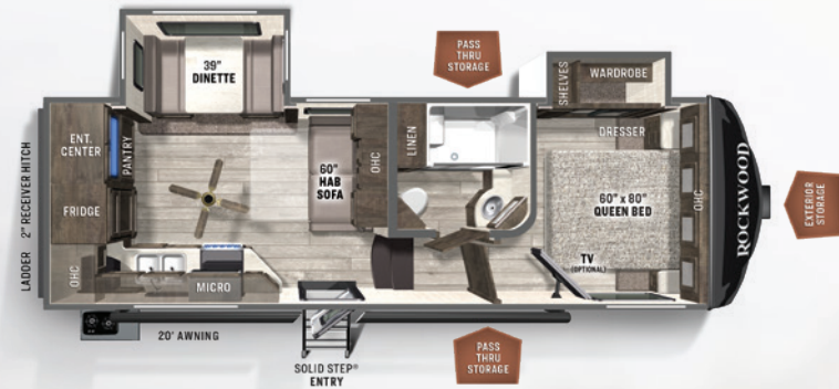
2445WS CUISINE ARRIÈRE ULTRA LITE PVV: 7764 TIMON: 1215 ESSIEUX: 6490 CC: 2051 LONGEUR: 28'11" LARGEUR: 8' HAUTEUR: 13'1" FRAÎCHE: 54 gal GRISÉS: 80 gal NOIRES: 40 gal
