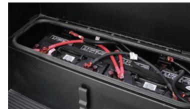
Deux batteries rangées au même endroit afin d'en faciliter l'accès. (Une batterie sur les modèles LE et Transit)
