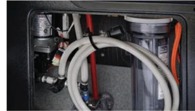
Tuyau d'hivernisation facile d'accès pour une maintenance rapide et inclut une valve de dérivation sur le chauffe-eau. (N/D 2251SLE, 2551DSLE)
