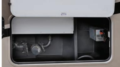
Station utilitaire fermée. Vos réservoirs et valves sont protégés, grâce à l'air chaud provenant de la fournaise. (N/D 2251SLE, 2551DSLE, MBS et Transit)
